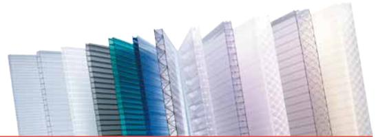
**Exolon® multi UV 4/10-6** ist eine 4fach-Stegplatte aus Polycarbonat mit einer Dicke von 10 mm. Sie vereint hohe Lichtdurchlässigkeit mit ausgezeichneter Wärmedämmung und guter Lastabtragung dank ihrer Y-Struktur. Die Platte ist leicht, schlagzäh und einfach zu verlegen.
