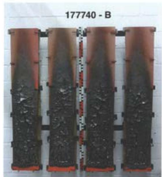
Bild 4: Aussehen der Proben des Probekörpers B nach 10-minütiger Beflammung
