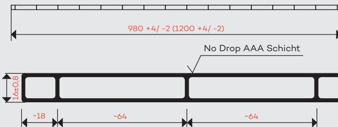
Querschnitt der PLEXIGLAS® Resist AAA SDP 16-64 (Maße in mm)
